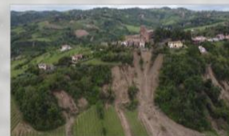
Figura 81: Esempio della ricorrenza di colate in terra nelle aree più colpite. Sono visibili due tipi di frane, tra il versante in prima piano e quello in secondo piano. Le frane sono state classificate al Romagnolo (R.C.). Da: https://www.romagnolo.it/romagnolo/2023/05/28/romagnolo-perse-opportunita-di-avere-frontera-robusta-da-frane-e-roccia-rotta
